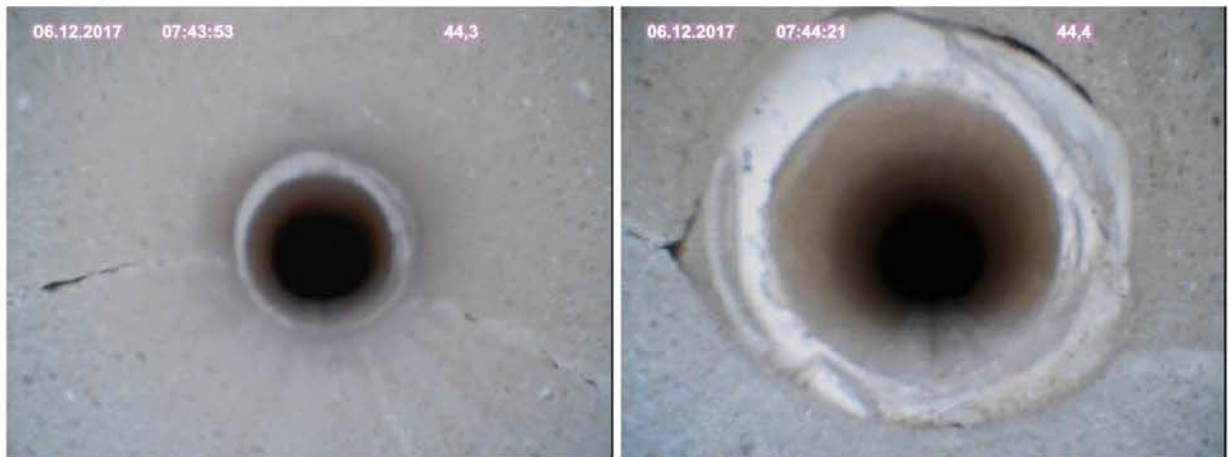
(c) Riss in der östlichen und westlichen Bohrloch- (d) Kluft im Bohrloch wand
