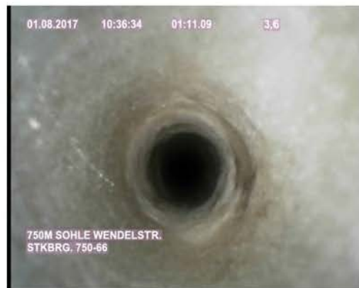
Bild 21: Geschlossener potentieller Riss (StKBrg.750-66, Teufe: 3,60 m)
