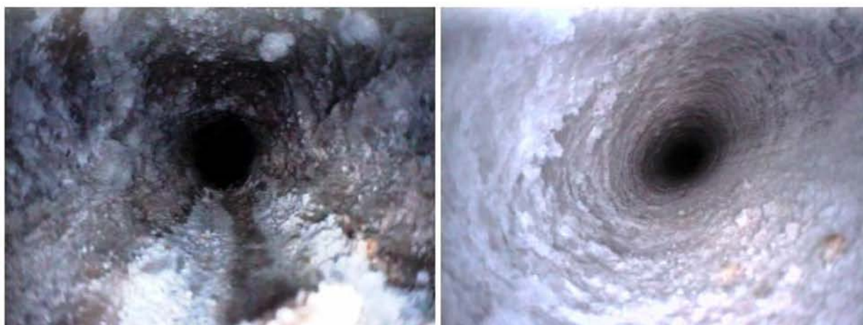
(a) Salzausblühungen als Hinweis auf Feuchtigkeit (b) Beanspruchter Bereich mit elliptisch verformtem Bohrlochquerschnitt bei ca. 40,0 m
