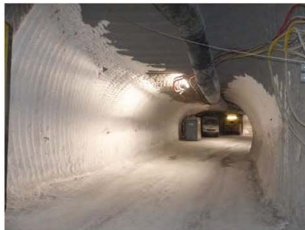
(b) Nachgeschnittener Nordstoß im westlichen Teil der nördlichen Richtstrecke nach Osten, Blick nach Osten, 22.01.2018
