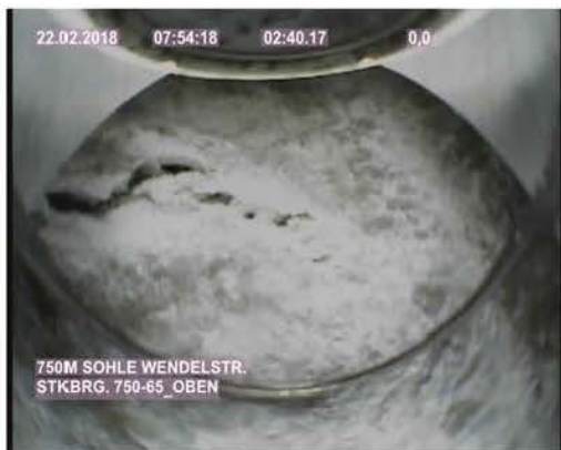
Bild 20: Konturnahe Auflockerung bis 20 cm (StKBrg.750-65, Teufe: 0,05 m)
