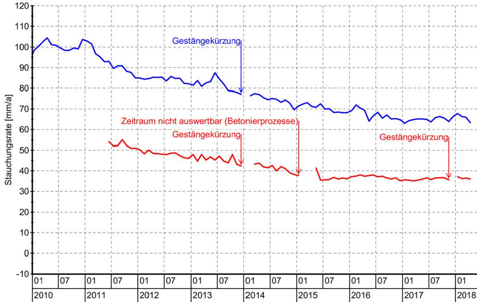
Mittelwert über die monatlich berechneten Stauchungsraten in der Pfeilerreihe 5/6
